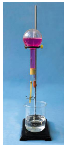
图6氨的溶解性实验
