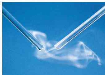
图 7 氨跟氯化氢的反应
